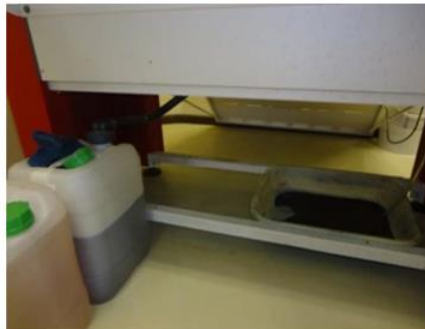
Figura 7: Resíduos da marcação das chapas de alumínio na máquina gravadora e resíduo da goma utilizada no processo de revelação das chapas de alumínio.
