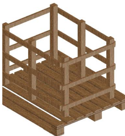
Figura 2: estrutura do contêiner a partir de pallets de madeira.
