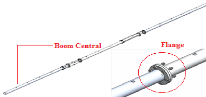
Figura 5: Boom central da antena seccionado em três partes Fonte: Pesquisa (2015)
