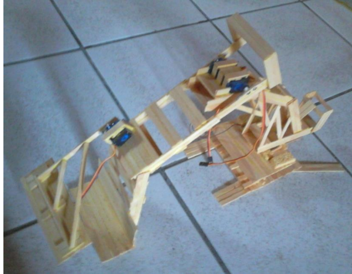
Figura 12. Parte mecânica do guincho robótico finalizado
