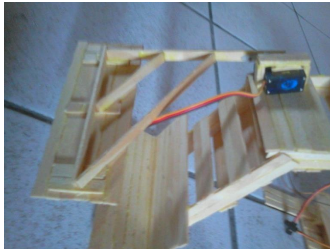
Figura 11. Estrutura da garra com motor fixado
