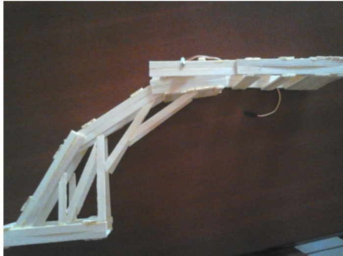
Figura 9. Esqueleto do braço desmontado com os motores superiores fixados
