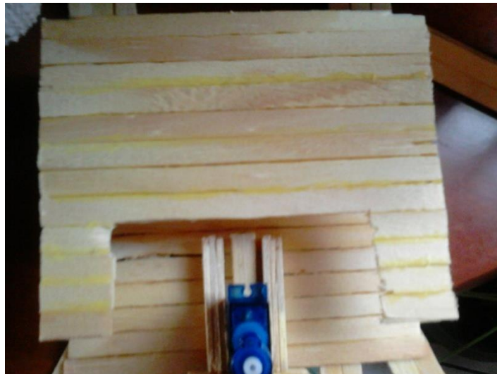
Figura 5. Plataformas encaixadas com suporte lateral para o primeiro motor
