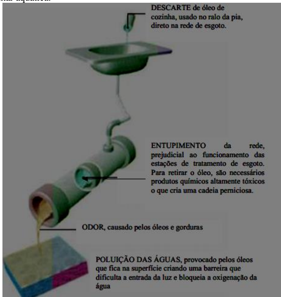
Figura 1: Processo de saponificação da gordura na tubulação após seu lançamento na pia. Fonte: DIÁRIO DE NATAL (2007).
