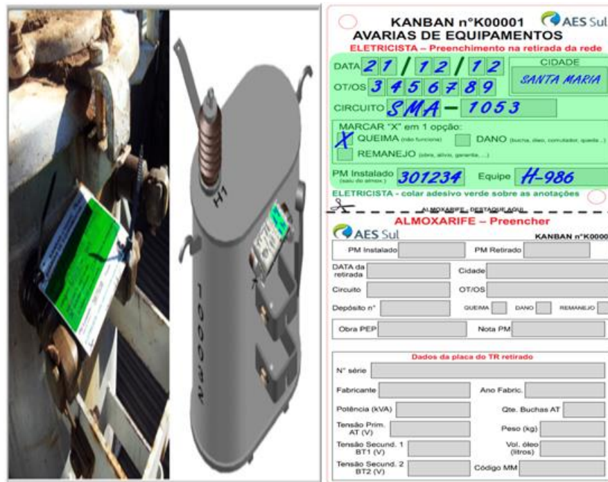
Figura 4 – Ilustrações do controle de produção por kanban na logística reversa de transformadores da AES Sul. Fonte: Criado pelo autor.
