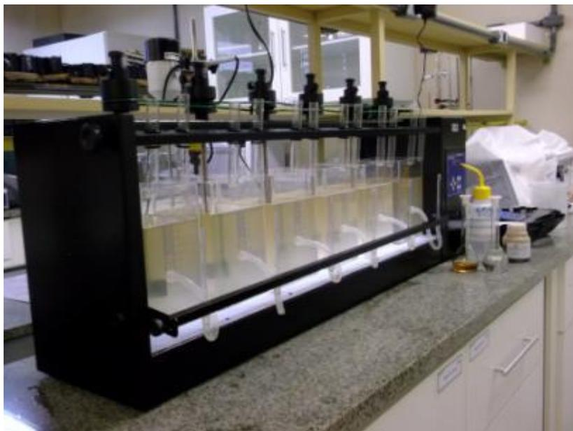
FIGURA 2: Vista do equipamento *Jarrest* (Fonte: Autores)
