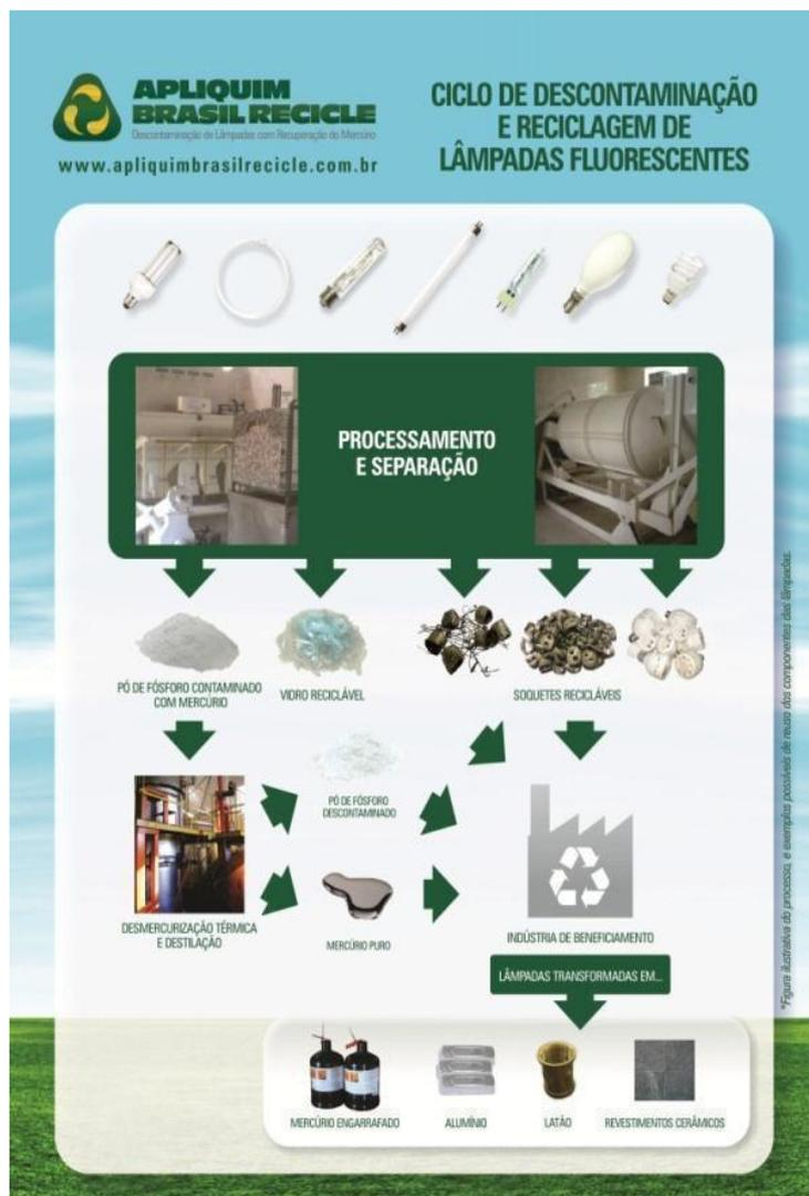
Figura2: O processo de reciclagem dos diversos tipos de lâmpadas.
