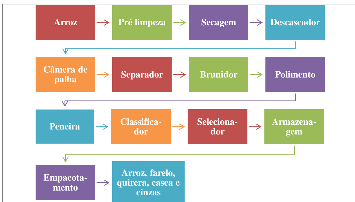
Figura 1- Fluxograma do Beneficiamento do Arroz na COAGRIJAL
