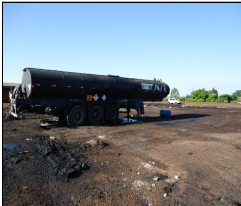
Ilustração 01 – Vazamento de CAP do caminhão-tanque (lateral)
