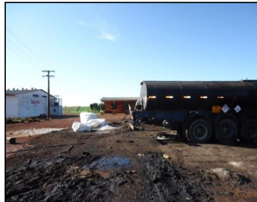
Ilustração 02 – Vazamento de CAP do caminhão-tanque (lateral/traseira)
