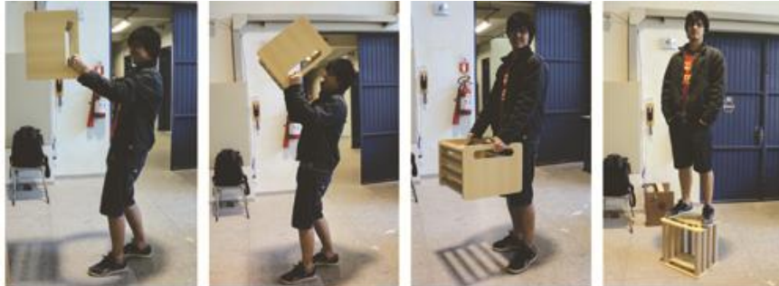
Verificação de tamanho, resistência e pega como módulo de estante, caixa e banqueta
